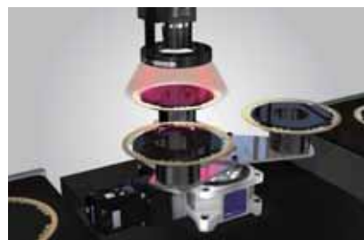
組付け品質画像検査テーブル
